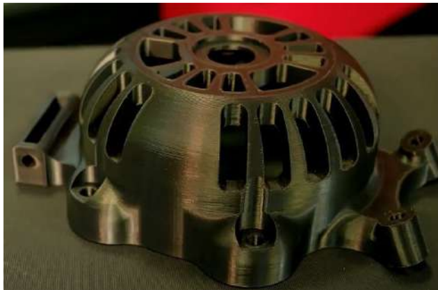
شکل 4- یک نمونه نسبتاً بزرگ ساخته شده به روش چاپ سه بعدی
